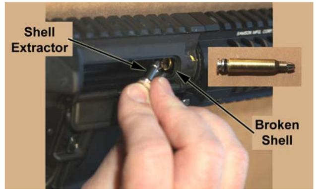
**2.8.2 Eject Broken Shell**
